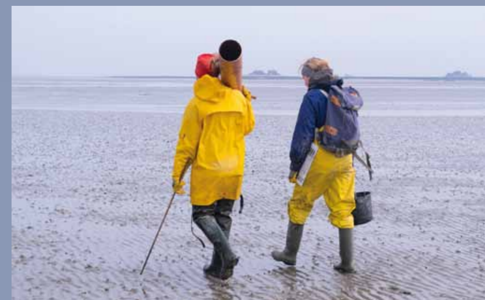
Nur mit vereinten Kräften lässt sich das Föhler Watt zur Freigabe des großen Stechröhres mit Bodenprobe überreden.
