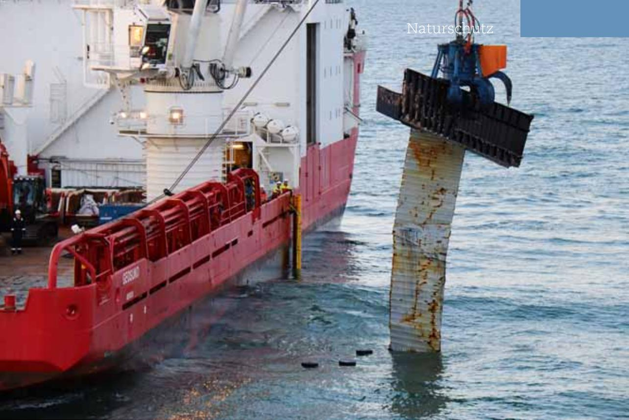
Offenbar sind viele Container nur noch Schrott. Durch die Bergung mit einfachen Greifern werden kleine Müllteile eher im Wasser verteilt als an die Oberfläche geholt.
